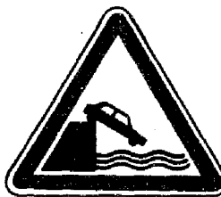
A20 – Débouché sur un quai ou une berge
