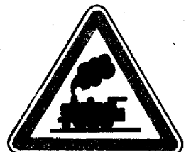
A8 – Passage à niveau sans barrière
