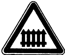
A7 – Passage à niveau muni de barrières
