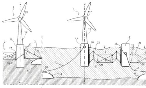
⑪ Structure porteuse d'installation de modules de captage d'énergie éolienne comprenant :
