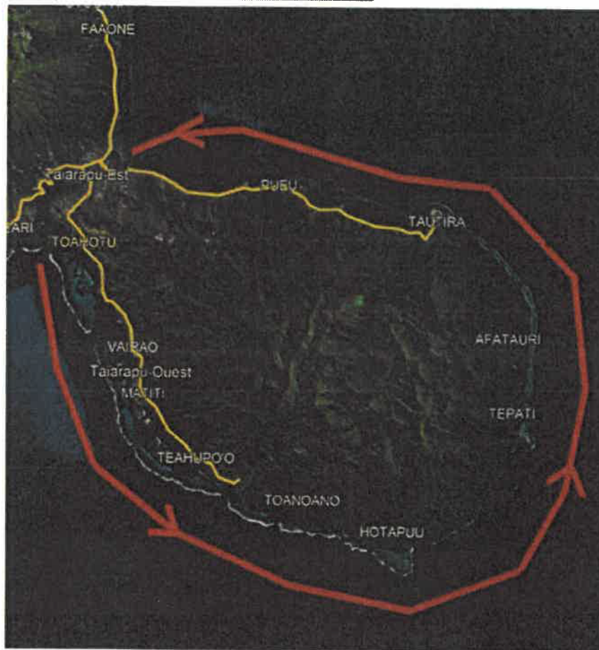
Schéma indicatif de la configuration de remorquage des sections de conduite (270m et 700m)
