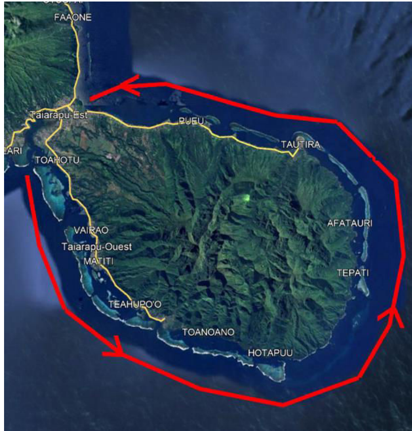
Schéma indicatif de la configuration de remorquage des sections de conduite (270m et 700m)
